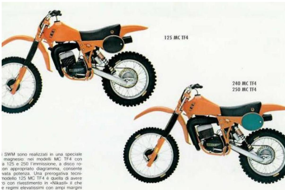
i SWM sono realizzati in una speciale magnesio: nei modelli MC TF4 con a 125 e 250 l'immissione, a disco rotton appropriato diagramma, consente vata potenza. Una prerogativa tecnico-modello 125 MC TF4 è quella di avere o con rivestimento in «Nikasil» il che regimi elevatissimi con ampi margini
